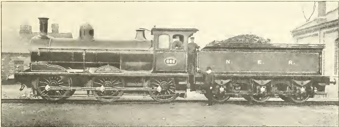
FIG. 319.—T. W. WORSDELL'S COMPOUND GOODS ENGINE, N. E. R. L., 1886-92
